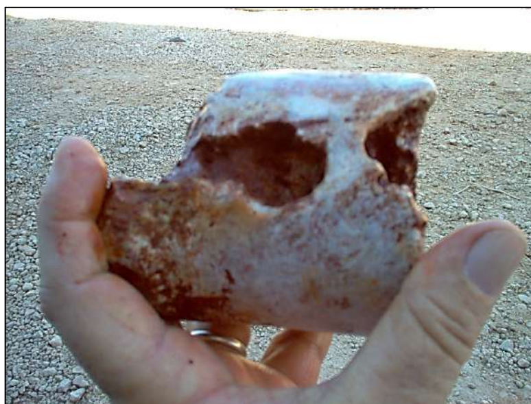
Fig. 15. Calizas cavernosas del epikarst local en el sitio de perforación y ensayo.
