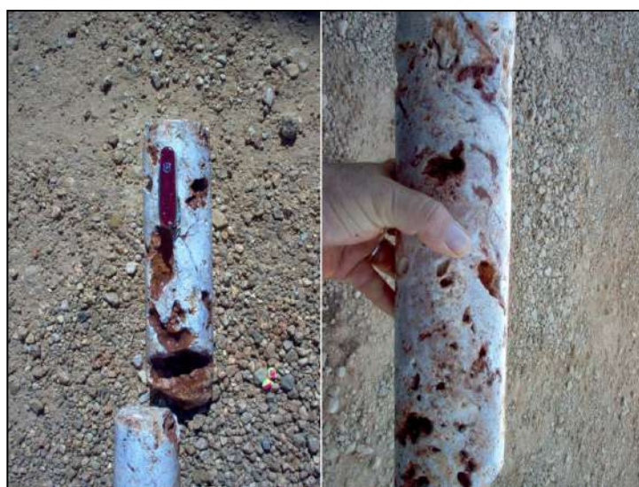
Fig. 15. Calizas cavernosas del epikarst local en el sitio de perforación y ensayo.
