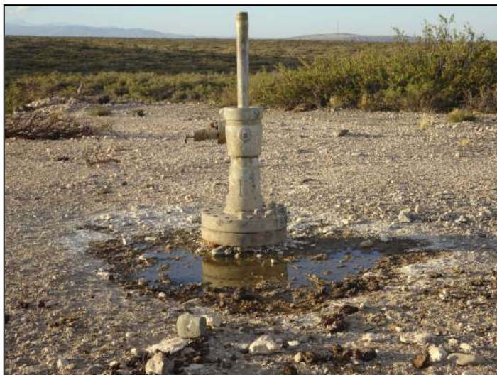
Fig. 1-b—Uno de los pozos abandonados en Puesto Rojas, donde puede apreciarse el fluir de aguas subterráneas con un fuerte olor a hidrocarburo.
